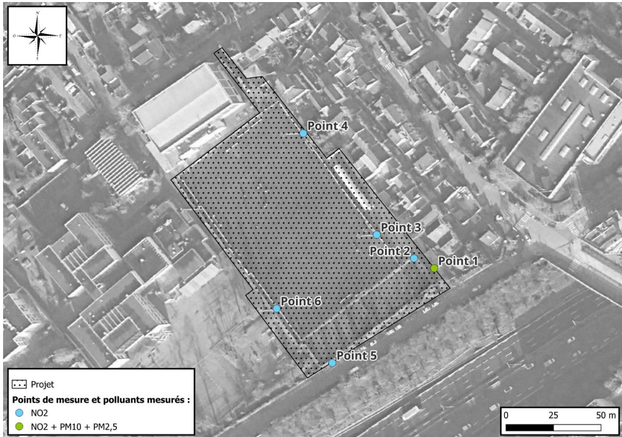
Figure 15 : Localisation des points de mesure sur la zone du projet
