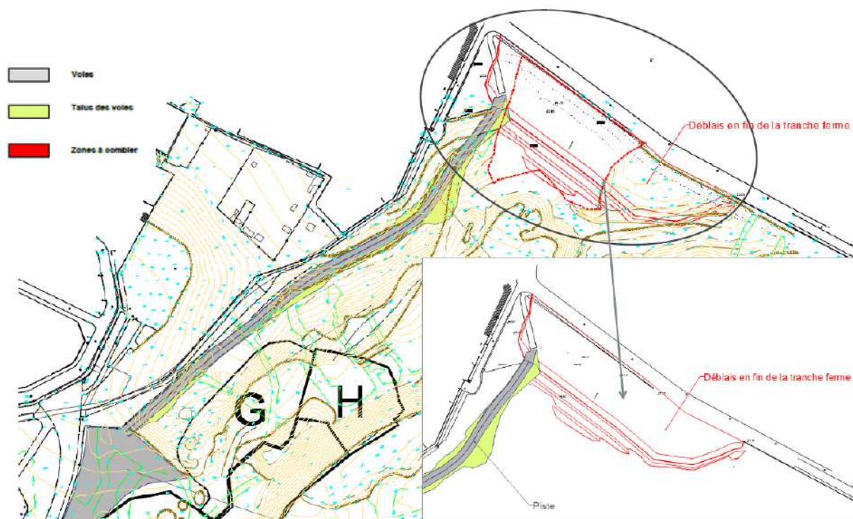
Figure 14 : Terrassements des pistes et remblaiement - piste A
