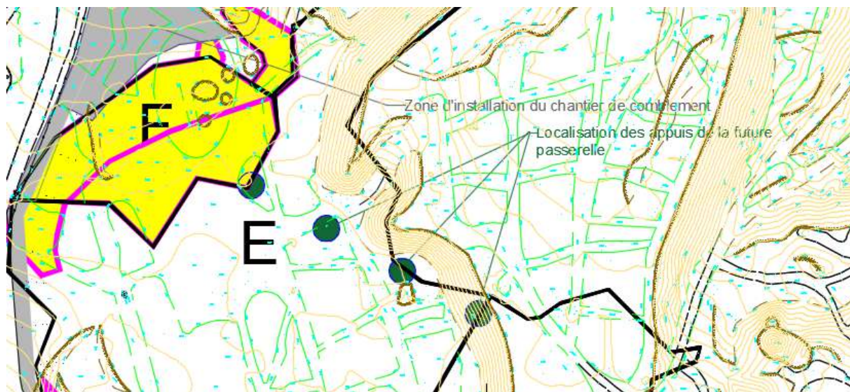
Figure 17 : Localisation des appuis de la future passerelle
