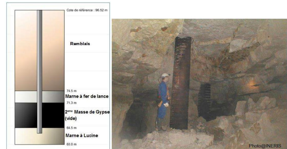
**Figure 34 : Exemple de profil de pieu au niveau de l'appui N°3 et photographie de pieux traversant – source :EGIS**
