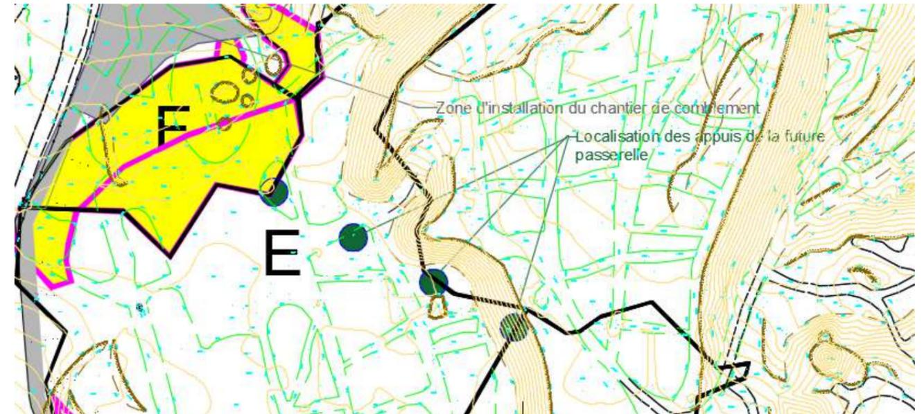
La mise en œuvre des pieux se fera par le biais d'une machine adaptée qui nécessitera un débroussaillage préalable.
