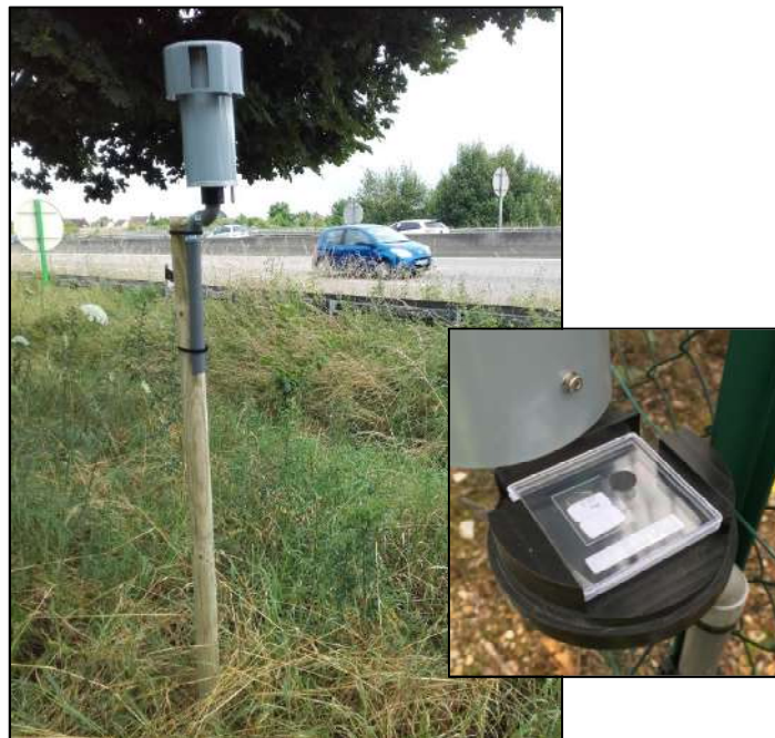
Figure 20 : Photographie du dispositif de prélèvement des poussières PM10
