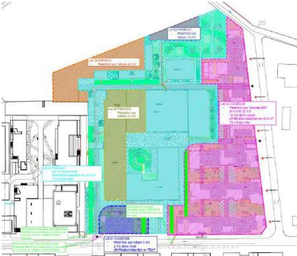
Figure 133 : Plan de gestion des eaux pluviales (31/05/2019)
