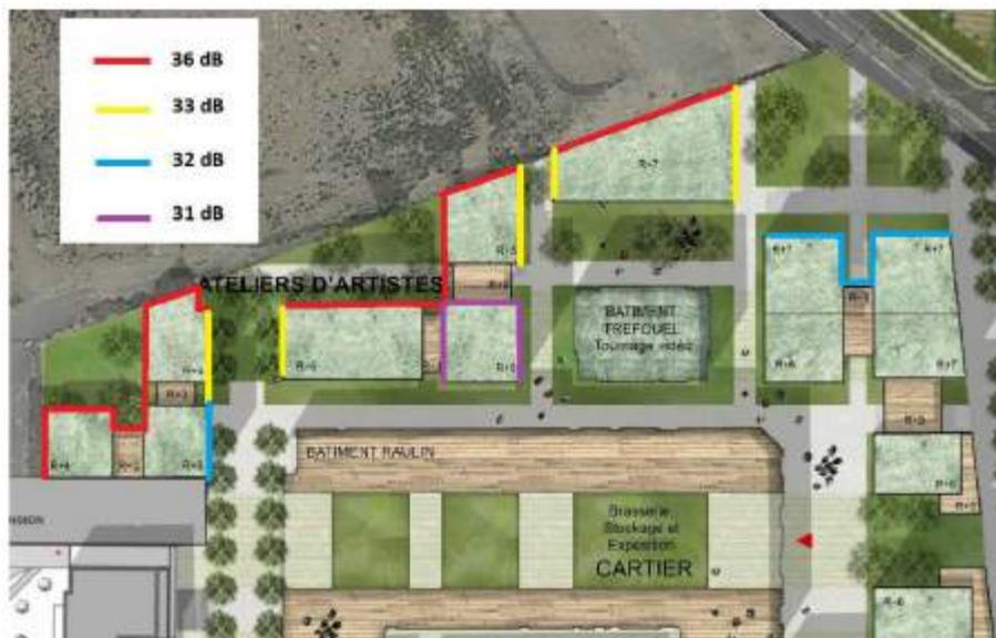
Figure 7 : Isolement minimal des façades selon le plan masse février 2019 (Arundo Acoustique)
