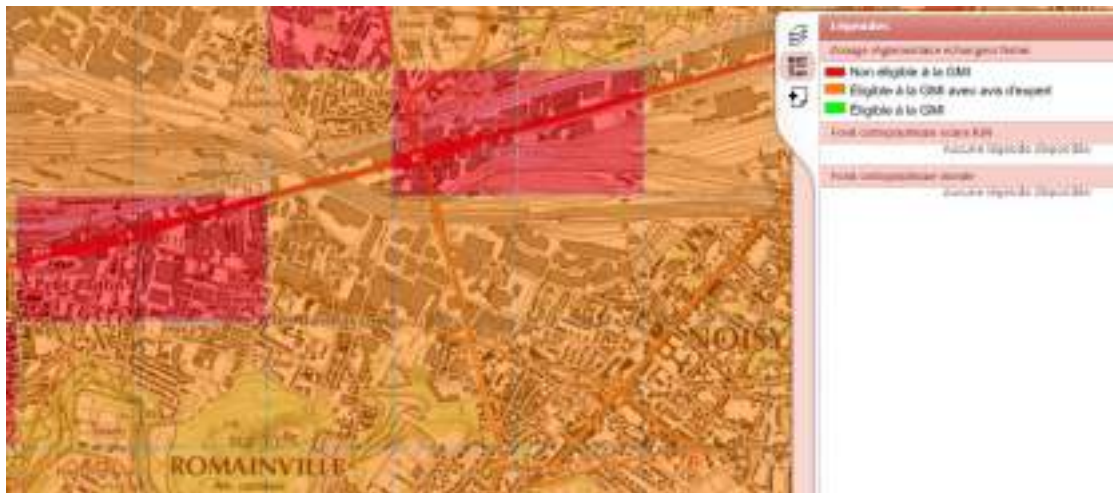
Figure 15 : éligibilité à la géothermie de minime importance du projet pour les installations sur sondes verticales (échangeur fermé)
